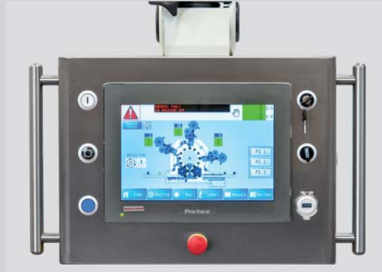
Pannello touchscreen su braccio pivotante Touchscreen panel on pivoting arm Pupitre tactile sur bras pivotant Panel touchscreen con brazo pivot Touchscreen-Bedienfeld auf schwenkbarem Arm
